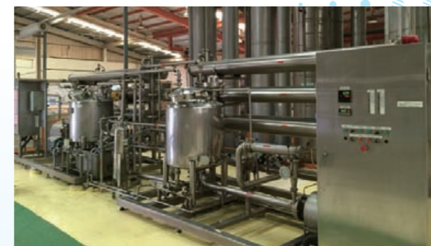
增設一台分子篩過濾系統 (UF) · 降低濃縮蒸氣用量
