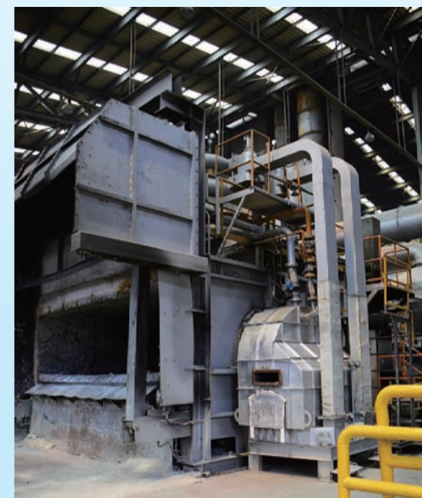
熱能節能改善 - 採用蓄熱式燃燒器節能
