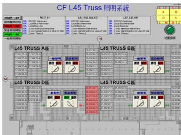
圖二 無塵室Truss區域照明由圖控電腦管制畫面
