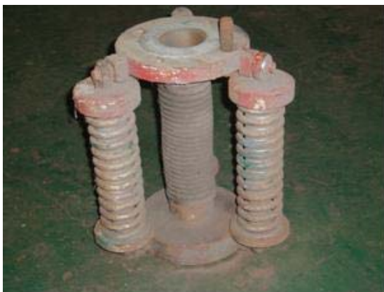
原有 LPG 銜接管路緩衝管套接
