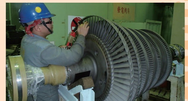
定期檢修維持蒸汽渦輪發電機高效率運轉 - 汽輪機葉片檢修
