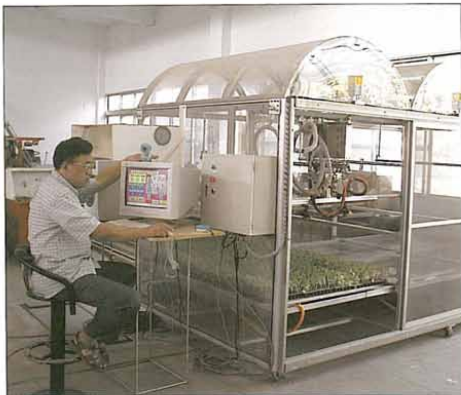
使用溫室模型及電腦、影像處理科技，測試與改良自動噴霧系統
