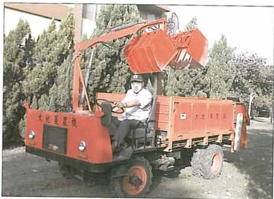
試驗操作所研發試製成功之新型自走式有機肥撒佈機
